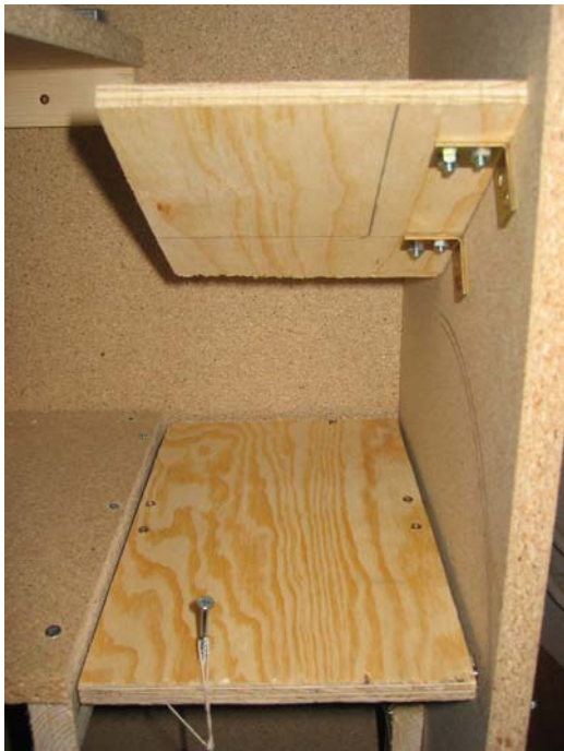
Tippbrädan (här med en skruv). Plankan ovanför tippbrädan ser till att godiset hamnar på rätt sida av tippbrädan.
